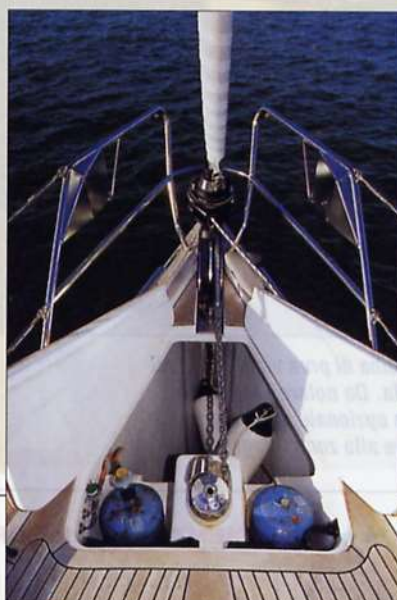
Sopra, il tambuccio con ai lati i due caratteristici pianali di appoggio incoppalati. Sotto, la discutibile sede delle bombole del gas, poste nel pozzo catena.
