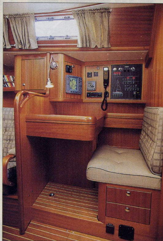
Sopra, la zona carteggio dispone di un piano di 60x80 cm con sopra la console angolata per gli strumenti. Confortevole la seduta, sotto cui si aprono due capienti cassetti.
